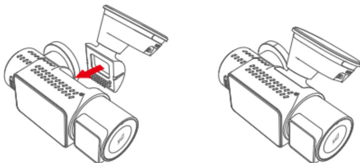
**Hinweis:** Achten Sie bei der Installation darauf, dass die Schnittstelle horizontal ausgerichtet ist. Ein deutliches Klicken signalisiert die korrekte Installation. Um eine vollständige Haftung auf der Montagefläche zu gewährleisten, muss vor der Montage die Schutzfolie auf der Klebefläche entfernt werden.
