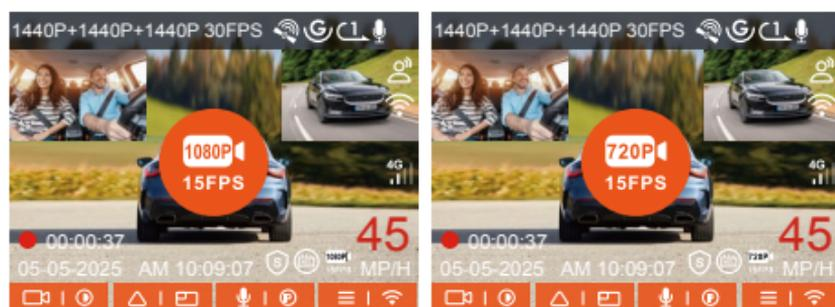
**So gelangen Sie hinein:** Nach dem Parken und Abstellen des Motors wechselt das Gerät automatisch in den Niedrigauflösungsmodus, die Auflösung aller Objektivs wird auf den eingestellten Wert angepasst und die Loop-Aufnahme wird entsprechend der Dauer aufgezeichnet.
