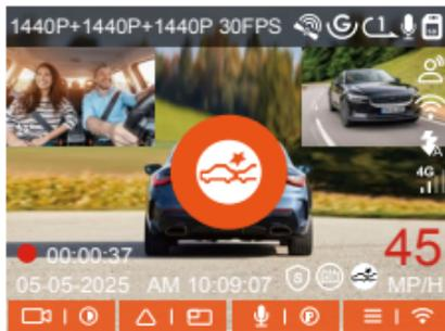
Wenn der G-Sensor erkennt, dass das Fahrzeug 5 Minuten lang stillgestanden hat (Eintritt in den Kollisionserkennungsmodus), wird das entsprechende Symbol in der Mitte des Rekorderbildschirms angezeigt und der Rekorder wird automatisch abgeschaltet. Wenn das Fahrzeug nach dem Herunterfahren vibriert oder sich bewegt, schaltet sich der Rekorder automatisch ein und zeichnet 30 Sekunden Video auf. Anschließend schaltet er sich wieder ab, um sicherzustellen, dass wichtige Bilder aufgezeichnet werden.
