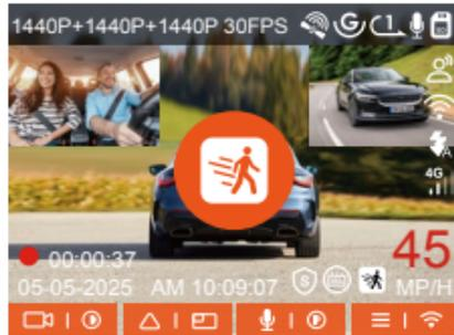
Wählen Sie im Parkmodus eine Kamera aus und passen Sie den Überwachungszone an, um Aktivitäten innerhalb eines bestimmten Bereichs genauer zu überwachen. Diese Funktion wird in Verbindung mit dem Parkmodus mit Bewegungserkennung verwendet, um sicherzustellen, dass das Gerät automatisch eine Aufzeichnung auslöst, wenn eine ungewöhnliche Bewegung erkannt wird. Dies verbessert die Überwachungseffizienz und reduziert ungültige Aufzeichnungen.
