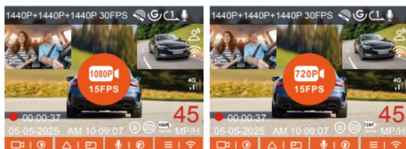
**Método de activación:** Después de estacionar y apagar el motor, el dispositivo entra automáticamente en el modo de baja tasa de bits, ajustando la resolución de todas las lentes al valor preestablecido y grabando según la duración configurada para la grabación en bucle.
